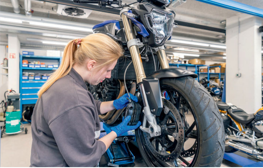
◀ Jennifer von Büren montiert die Bremsanlage neu.
